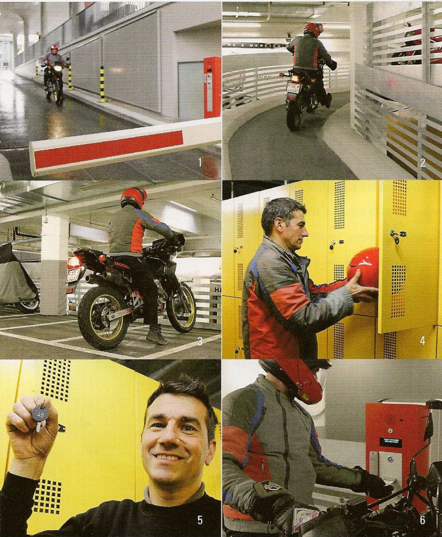
1. José P. Pereira fährt ins Casino Parking. Eine Induktionsschleufe im Boden stellt fest, ob es sich um ein Motorrad oder um ein Auto handelt
